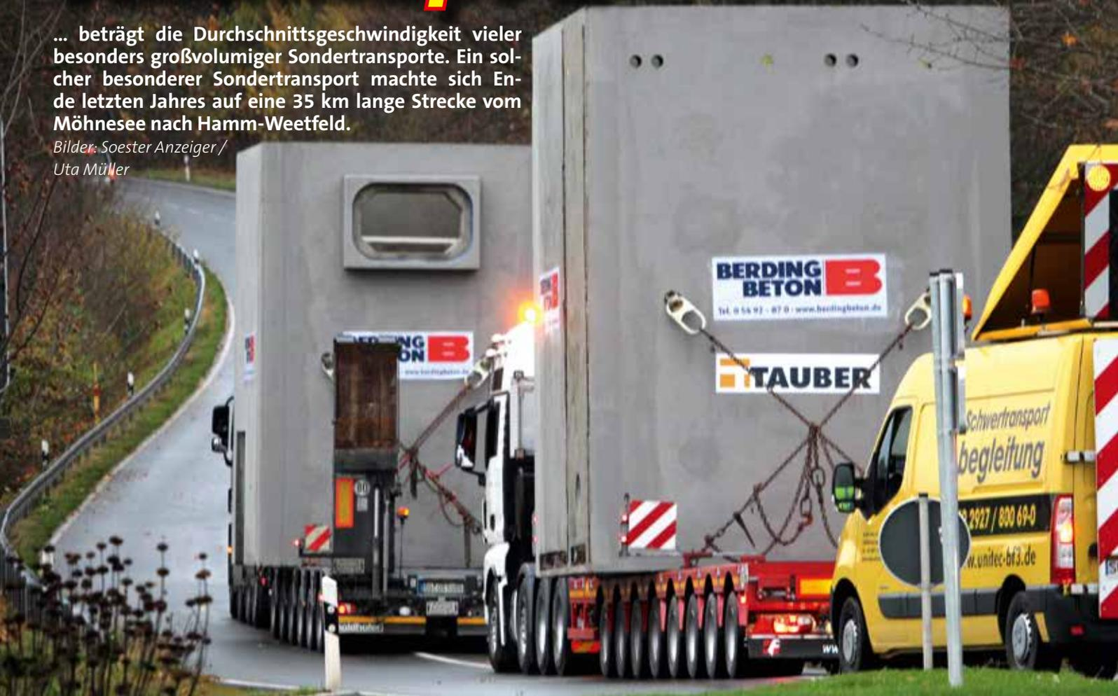
Es war eigentlich für alle Beteiligten ein ungewöhnlicher Auftrag. Für einen Kanal in Hamm-Weetfeld fertigte das Unternehmen Berding Beton mehrere Betonteile. Das an sich ist für das Unternehmen nicht so sehr ungewöhnlich, aber die Abmessungen waren es bei diesem Auftrag schon.
