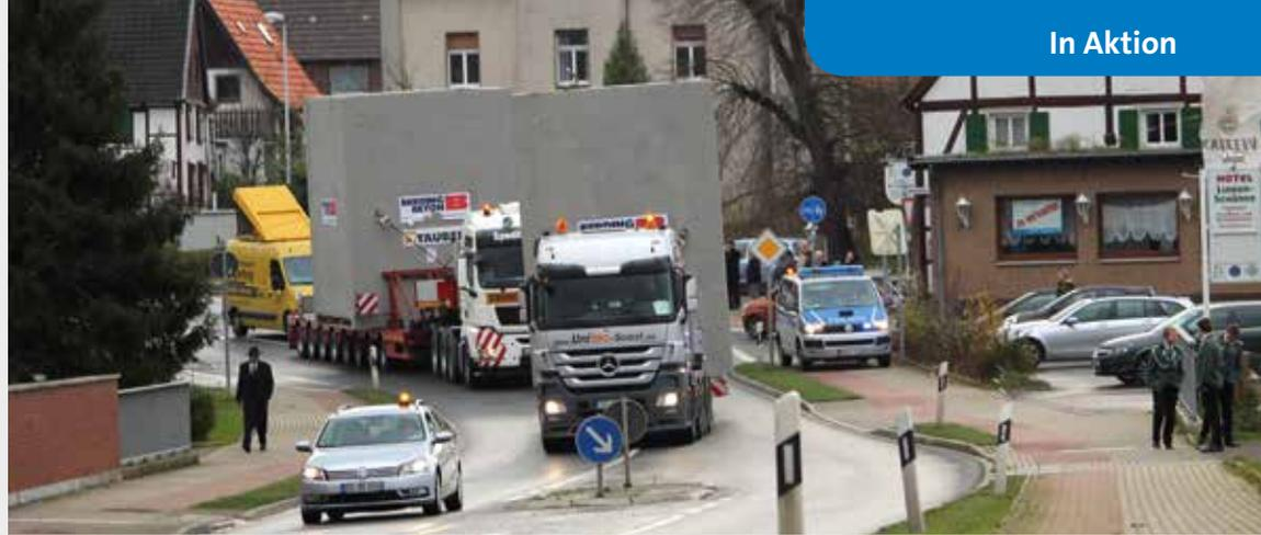
Aufgrund der Abmessungen konnten auf der Strecke vom Möhnesee nach Hamm-Weetfeld keine Brücken unterfahren werden.
