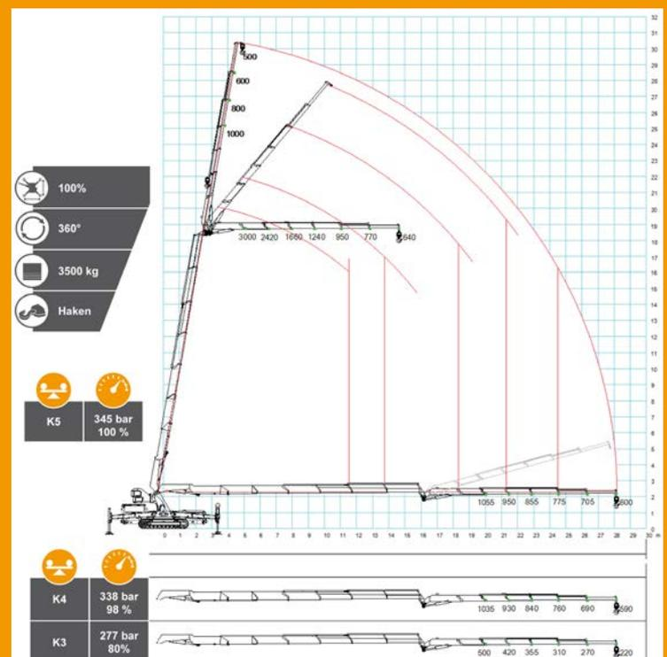
Konzipiert für den Einsatz im schwierigstem Gelände und auf engstem Raum - mit nur 1,84m Breite kommt der Raupenkran durch enge Zufahrten, kann als Kran wahlweise mit und ohne Seilwinde eingesetzt werden. Zudem sind 200kg Zuladung im Arbeitskorb bei 29m Auslage möglich!
