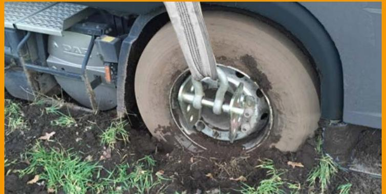
Radanschläger, Anheben ohne weitere Beschädigungen am Fahrzeug.
