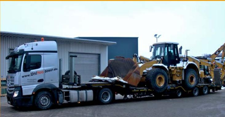
Auffahrbare und teleskopierbare Semi-Tieflader mit Nutzlasten bis 50 to.
