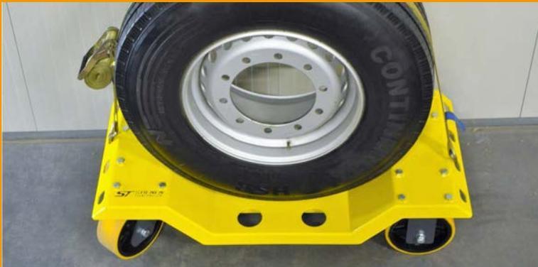
Radroller, für kürzere Entfernungen zum Abschleppen bei beschädigten Achsen.
