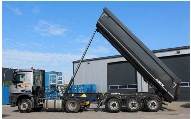
Sattelkipper mit Hardox-Mulde und Allrad-Zugmaschine fürs Gelände und Schüttgüter aller Art.
